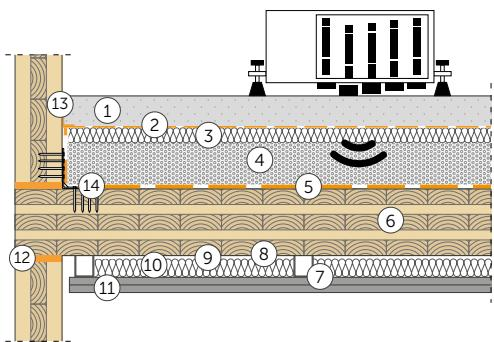
① Solera de cemento (2400 kg/m<sup>3</sup>) (e: 60 mm)
