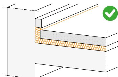
La capa resiliente debe ser continua porque cualquier solución de discontinuidad representaría un puente acústico. Cuando se instalan las láminas bajo la solera hay que prestar atención en no crear discontinuidades.
