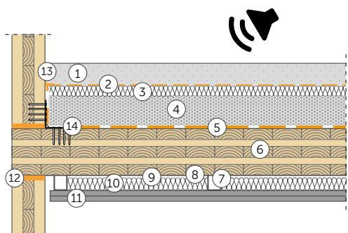
① Solera de cemento (2400 kg/m<sup>3</sup>) (e: 60 mm)
