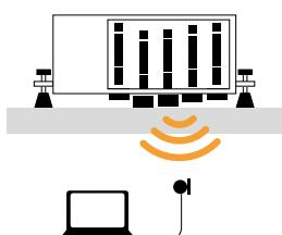
La *TAPPING MACHINE* se utiliza para simular impactos "ligeros" y "fuertes", como los de caminar con tacones o los de la caída de objetos.
