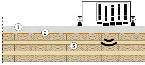
① Solera de cemento (2600 kg/m<sup>3</sup>) (e: 50 mm)
